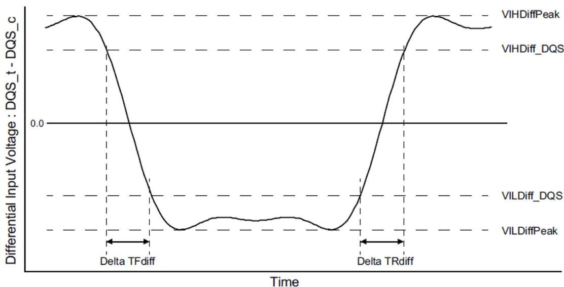
Figure 14. Differential Input Slew Rate Definition for DQS<sub>t</sub>, DQS<sub>c</sub>
